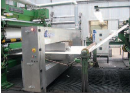
cartón. Con nuestros sistemas de control de calidad QCS proporcionamos al cliente una herramienta que le permite controlar la calidad del producto fabricado en continuo y en tiempo real. Además, le ofrecemos la realización de las correcciones oportunas
